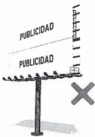
EJEMPLO: VALLA DE UN SOLO POSTE O COLUMNA CILÍNDRICA DE DOS PANTALLAS A CUATRO CARAS OPUESTAS.
